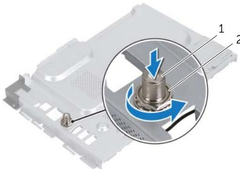
1 connecteur d'entrée d'antenne 2 écrou hexagonal
